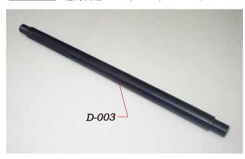
■マシンに取り付けたままハンマーでロールピンを外す 事は、シャフトが曲がる原因となりますので必ずニッパー 等を使用してください。RHマシンは特に注意が必要です。 (ロールピンの代わりにカッターピン《Z-843-1》も有ります。)
